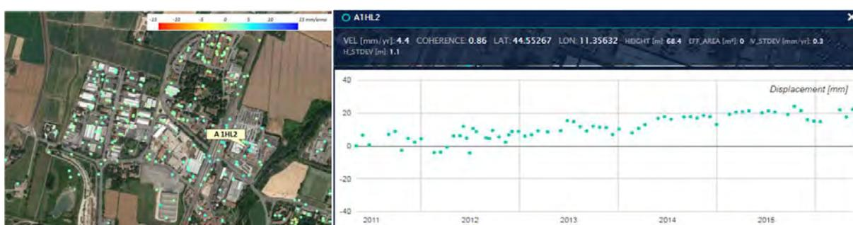
**Fig. 65** - Area di Bologna (Corticella) con evidenziati i PS/DS analizzati (a sinistra) e serie temporale del punto A1HL2 (a destra)
