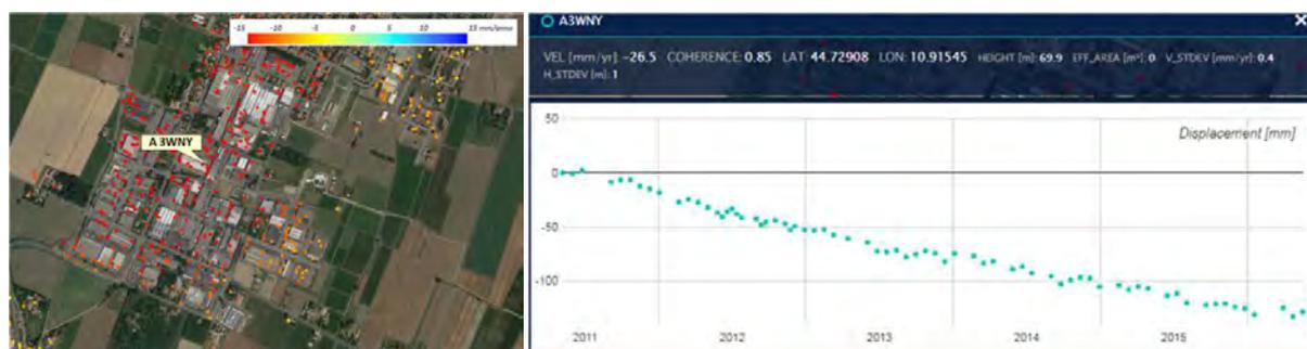
*Fig. 45 - Area di Soliera con evidenziati i PS/DS analizzati (a sinistra) e serie temporale del punto A3WNY (a destra)*
