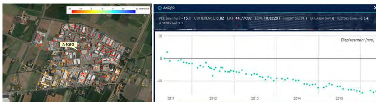
*Fig.44 - Area di Correggio con evidenziati i PS/DS analizzati (a sinistra) e serie temporale del punto A4QF0 (a destra)*
